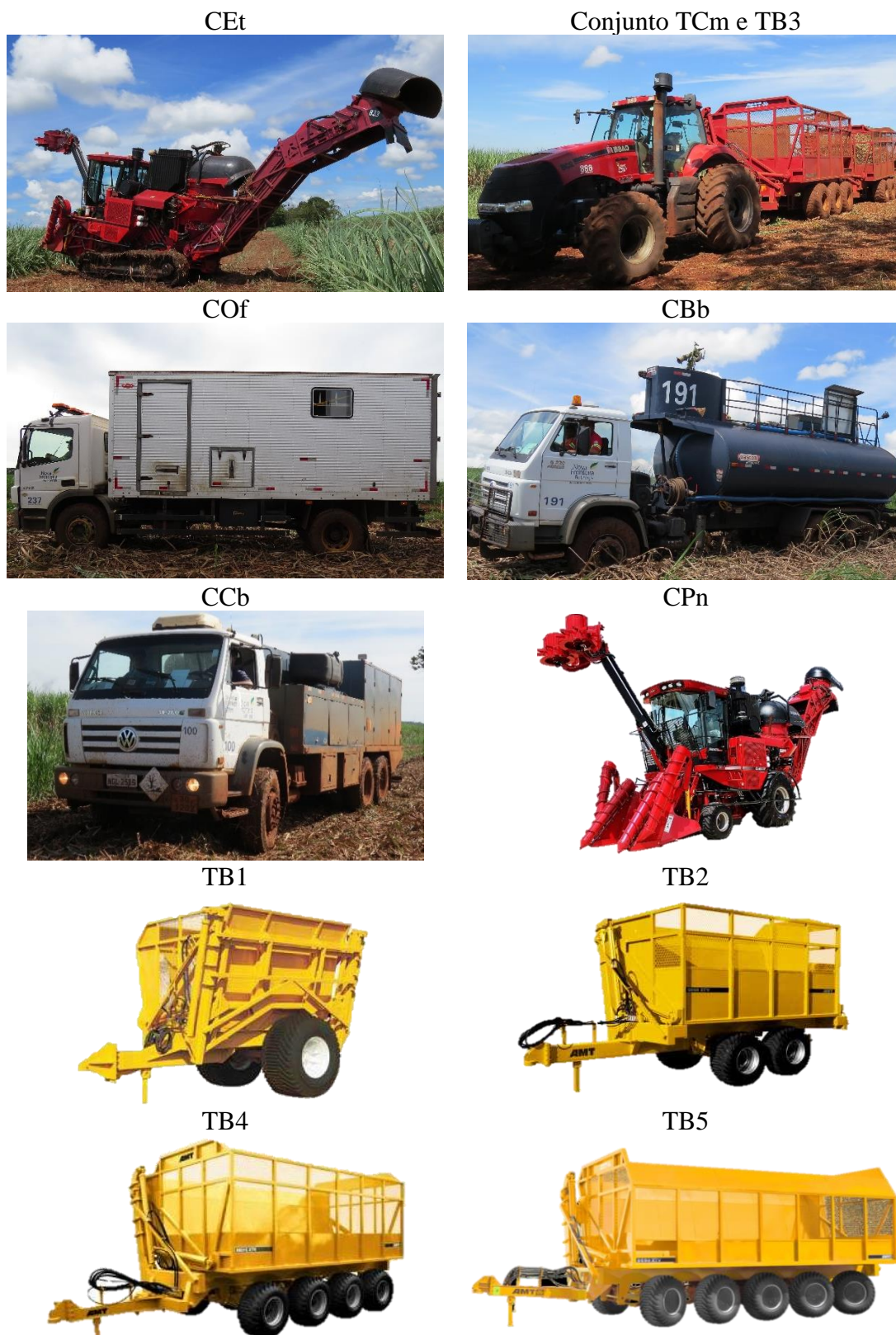
Figura 1. Maquinários ensaiados, utilizados na operação de colheita de cana-de-açúcar. Obs.: CEt: Colhedora de Cana-de-açúcar Case A8800 rodado de esteira metálica, TCm: Trator Case HI Magnum 235cv, COf: Caminhão Oficina BMW 1719 ATEGO; CBb: Caminhão Bombeiro VW 26 229 EURO com duplo eixo traseiro; CCb: Caminhão Comboio VW 31 260 E Wolker com duplo eixo traseiro, CPn: Colhedora de Cana-de-açúcar Case A8000 com rodado de pneus;; TB1: Transbordo SMR 8500 de 1 eixo; TB2: Transbordo VTX 10000 de 2 eixos; TB3: Transbordo VTX 14000 de 3 eixos; TB4: Transbordo VTX 21000 de 4 eixos; TB5: Transbordo VTX 6030 de 5 eixos;.
